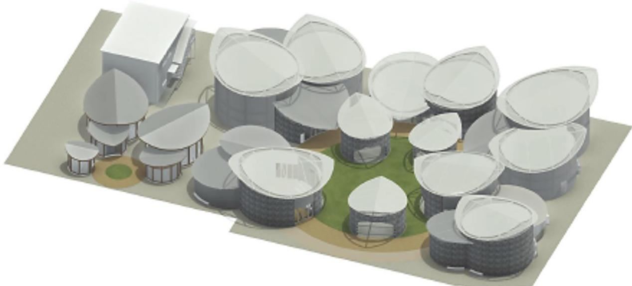
各機能に応じて大きさや高さが異なる円形ユニットは、屋根(山や谷、片流れ)と壁(鉄筋トラス壁や鉄骨壁)の各タイプの組み合わせで構成されています。各種の組み合わせ方のバリエーションによって、様々な空間が創出され木々が集まった森のように緩やかなまとまりを形成します。
