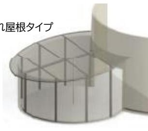
光や風を取り込む山屋根、雨水を集める谷屋根、効率的に室内を覆う片流れ屋根の3種類の屋根を配置し、それらが少しずつ重なることで柔かい木陰を生み出します。また中央の中庭に向かって傾斜する屋根は効率的に雨水を集めます。
